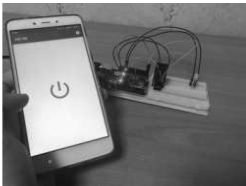
Рис. 2. Управление смартфоном работой светодиода
